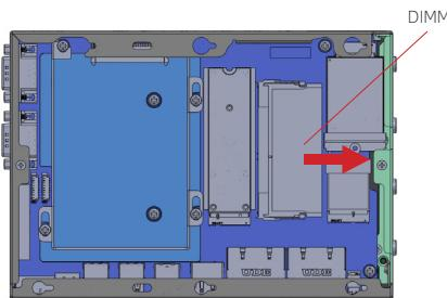
如上图：将 DIMM 插槽两端的卡榫同时向外推，然后拿出内存条。
