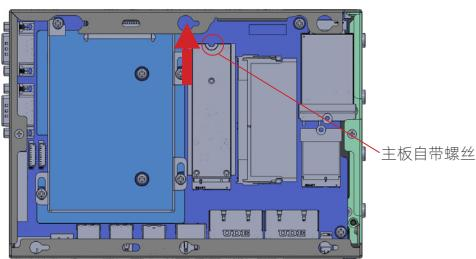
如上图：将锁 M.2 的1颗 M2 主板自带螺丝拧下，即可拿出 M.2 2242/2280 SATA SSD。
